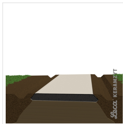
4. Przykrycie keramzytu geotkaniną
