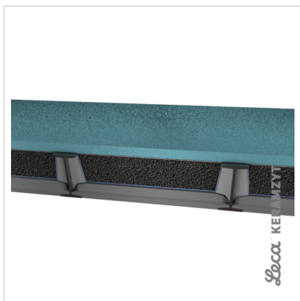
5. Izolacja akustyczna min. 3-5 cm
